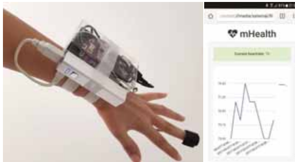
Slika 10. Wearable sistem za praćenje stresa kod studenata
